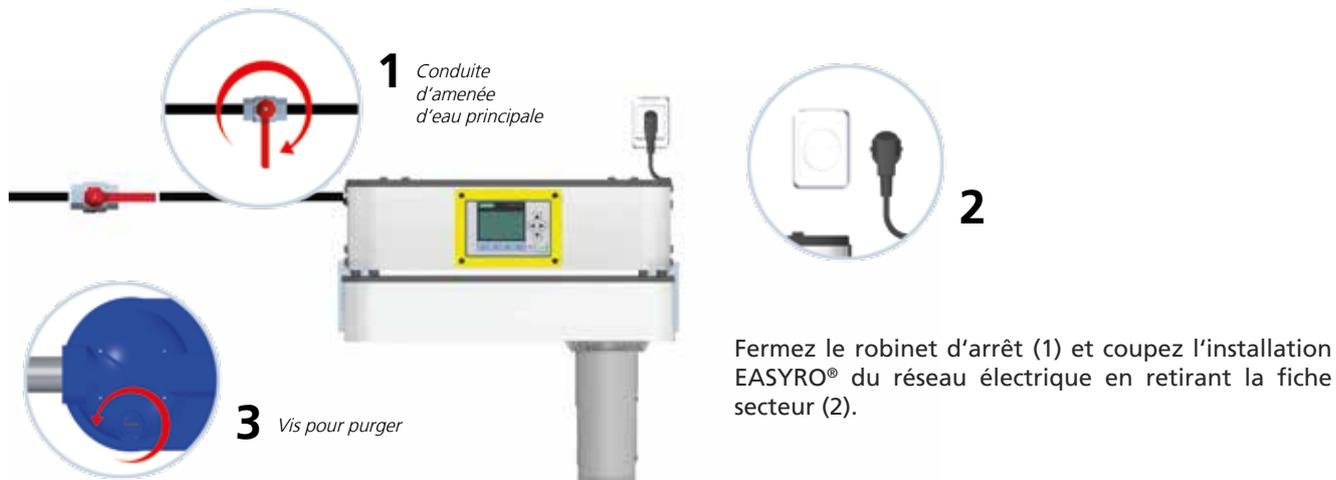
Si vous utilisez un réservoir à vessie, votre système de traitement de l'eau est sous pression. Pour abaisser la pression dans le système, dévissez la vis (3) sur le carter du filtre à l'aide d'un tournevis, jusqu'à ce que la pression puisse s'échapper.
