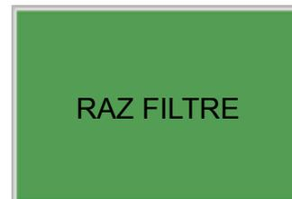
Pour l'affichage « CHANGER FILTRE », veuillez appuyer sur ESC + ▼ flèche vers le bas pour réinitialiser le filtre.
