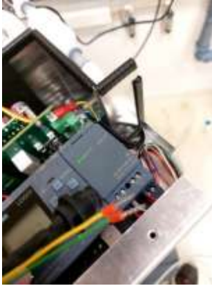
Kabelbaum in die EASYRO einsetzen
