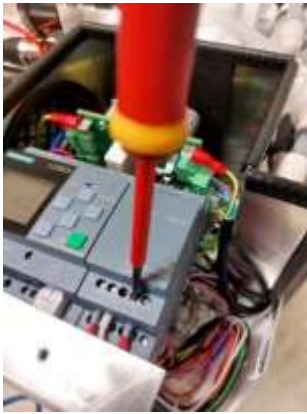
an der Steuerung Q2 anliegenden Pluspol abklemmen
